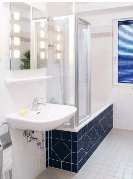
Bitte beachten Sie, dass im Spritzwasserbereich um die Badewanne/Dusche Bohrungen zu vermeiden sind, damit der feuchtigkeitsisolierende Anstrich seine Funktion nicht verliert. Sollten Sie trotzdem im Spritzwasserbereich etwas anbringen müssen, so dichten Sie die Bohrlöcher vor dem Setzen der Dübel mit Silikon ab.
